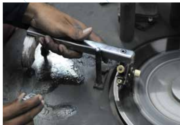
Die Diamantkettenteile werden in Klemmvorrichtungen eingespannt und auf diamantierten Scheiben facettiert. / Les divers éléments d'une chaîne de diamants sont assemblés dans un étai et facettés sur des disques au diamant.
