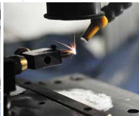
Die Diamantkettenteile werden mit der neusten Lasertechnologie gebohrt. / Les éléments des chaînes de diamants sont percés à l'aide des dernières technologies laser.
