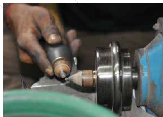
Schleifen der Diamanten: In einem ersten Schritt werden jeweils zwei Steine aneinander gerundet. / La taille des diamants. Au cours d'une première étape, deux gemmes sont toujours arrondies l'une contre l'autre.
