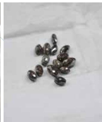
Die Diamantkettenteile werden in Klemmvorrichtungen eingespannt und auf diamantierten Scheiben facettiert. / Les divers éléments d'une chaîne de diamants sont assemblés dans un étai et facettés sur des disques au diamant.
