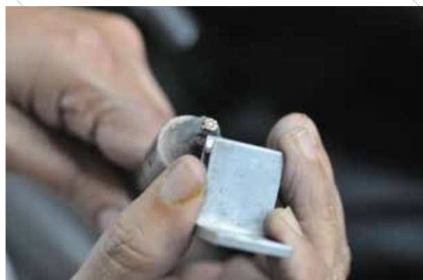
Schleifen der Diamanten: In einem ersten Schritt werden jeweils zwei Steine aneinander gerundet. / La taille des diamants. Au cours d'une première étape, deux gemmes sont toujours arrondies l'une contre l'autre.
