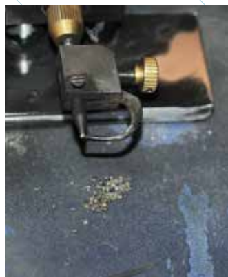
Die Diamantkettenteile werden mit der neusten Lasertechnologie gebohrt. / Les éléments des chaînes de diamants sont percés à l'aide des dernières technologies laser.
