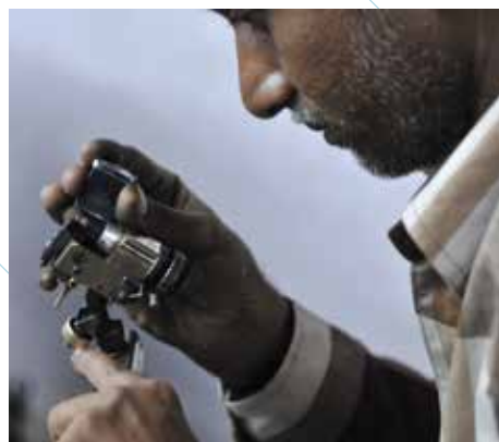
Die Diamantkettenteile werden in Klemmvorrichtungen eingespannt und auf diamantierten Scheiben facettiert. / Les divers éléments d'une chaîne de diamants sont assemblés dans un étai et facettés sur des disques au diamant.
