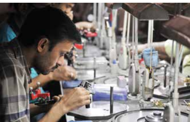
Schleifen der Diamanten: In einem ersten Schritt werden jeweils zwei Steine aneinander gerundet. / La taille des diamants. Au cours d'une première étape, deux gemmes sont toujours arrondies l'une contre l'autre.
