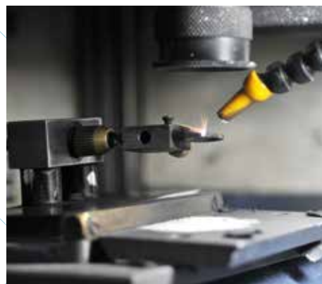
Die Diamantkettenteile werden mit der neusten Lasertechnologie gebohrt. / Les éléments des chaînes de diamants sont percés à l'aide des dernières technologies laser.
