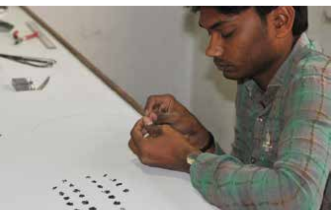
Ein Mitarbeiter zieht die Kettenteile auf Stahlkabel auf. / Un collaborateur assemble les éléments de la chaîne sur un fil d'acier.
