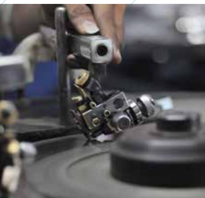
Die Diamantkettenteile werden in Klemmvorrichtungen eingespannt und auf diamantierten Scheiben facettiert. / Les divers éléments d'une chaîne de diamants sont assemblés dans un étai et facettés sur des disques au diamant.
